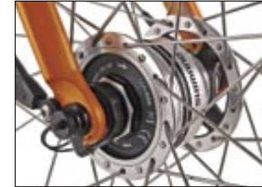
Neuste Technik: der leichtlaufende Shimano-Sportnabendynamo 3N80
