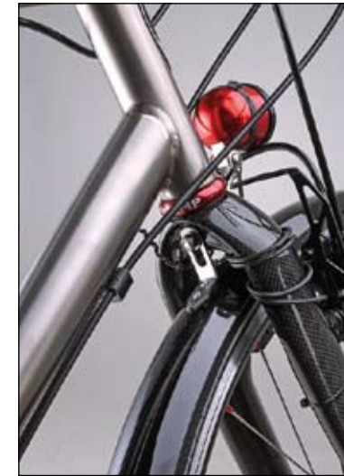
Das gefällt: feine Titanschweißnähte, Carbongabel und roter SON Edelux
