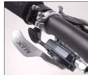
Keine Zurückhaltung: Der XTR-Hebel schaltet bis zu vier Gänge auf einmal.
